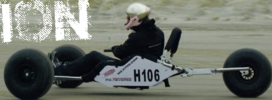
Der Reverse-MG ist ein ganz besonderer Kitebuggy, der von Maarten de Graauw vor allem als Fun-Projekt entworfen und gebaut wurde. Ein Dreirad mit lenkbarem Vorderrad und zwei starren Hinterrädern zu bauen war sicher die naheliegende Möglichkeit. Doch der Konstrukteur der Aero-Buggys wollte etwas ganz Neues machen – und so drehte er das Konzept des Buggys einfach um.
